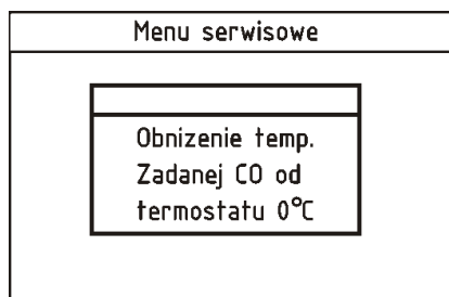
Rys. 33 Konfiguracja regulatora do współpracy z termostatem pokojowym
