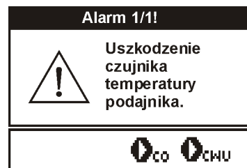
Rys. 49 Widok alarmu „uszkodzenie czujnika podajnika”
