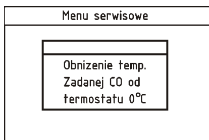
Rys. 29 Konfiguracja regulatora do współpracy z termostatem pokojowym
