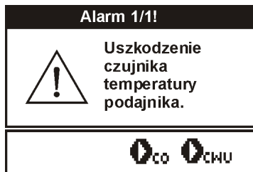
Rys. 46 Widok alarmu „uszkodzenie czujnika podajnika”
