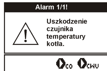
Rys. 45 Widok alarmu „uszkodzenie czujnika temperatury kotła”
